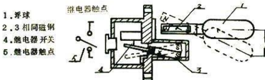
图一 工作原理结构
